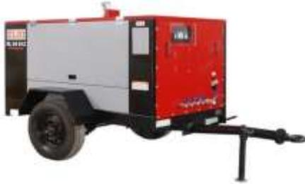
Gambar 5. Kompresor Diesel
